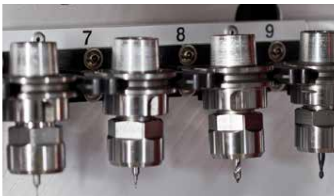
Инструментальный магазин с быстросменными паллетами
