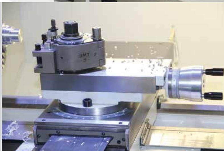
Несмотря на отдельные электродвигатели, продольная и поперечная каретка могут, как обычно, перемещаться вручную, при помощи маховичков. Их сцепление и расцепление происходит автоматически.
