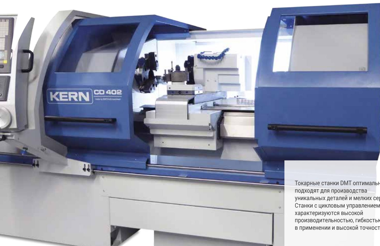
Токарные станки DMT оптимально подходят для производства уникальных деталей и мелких серий. Станки с цикловым управлением характеризуются высокой производительностью, гибкостью в применении и высокой точностью.
