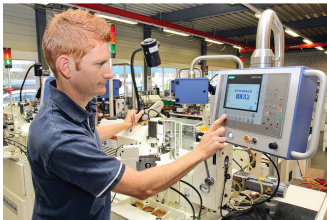
Михаэль Блойер, руководитель отдела новых разработок в компании Strausak, около станка HS32, небольшого компактного станка с цифровым управлением, электронным приводом и надежной в эксплуатации и простой в обслуживании системой управления Simatic. Благодаря его высокой надежности он особенно подходит для работы в круглосуточном режиме при скоростях резания до 1000 м/мин.
